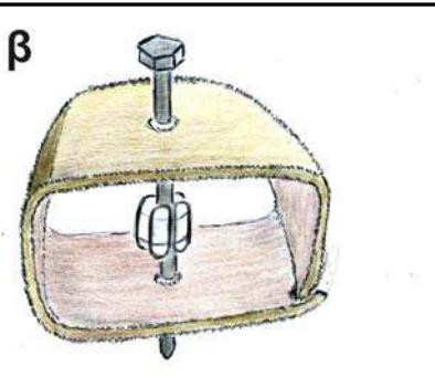
Παρατήρησε στην εικόνα β ένα αυτοσχέδιο δυναμό ή, όπως γενικά λέγεται, μια ηλεκτρική γεννήτρια. Φαίνεται ένα πλαίσιο από χαρτόνι, μια βίδα και μαγνήτες. Ποιο μέρος της ηλεκτρικής γεννήτριας νομίζεις ότι λείπει για να ολοκληρωθεί η κατασκευή της; Πού; Σχεδίασε.
